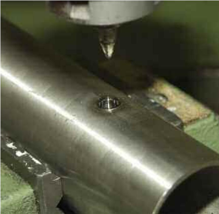
**Bild 9:** Das Fließbohren ist ein geeignetes Verfahren, wenn die Materialstärke nicht ausreicht, um genügend Gewindegänge einzubringen
