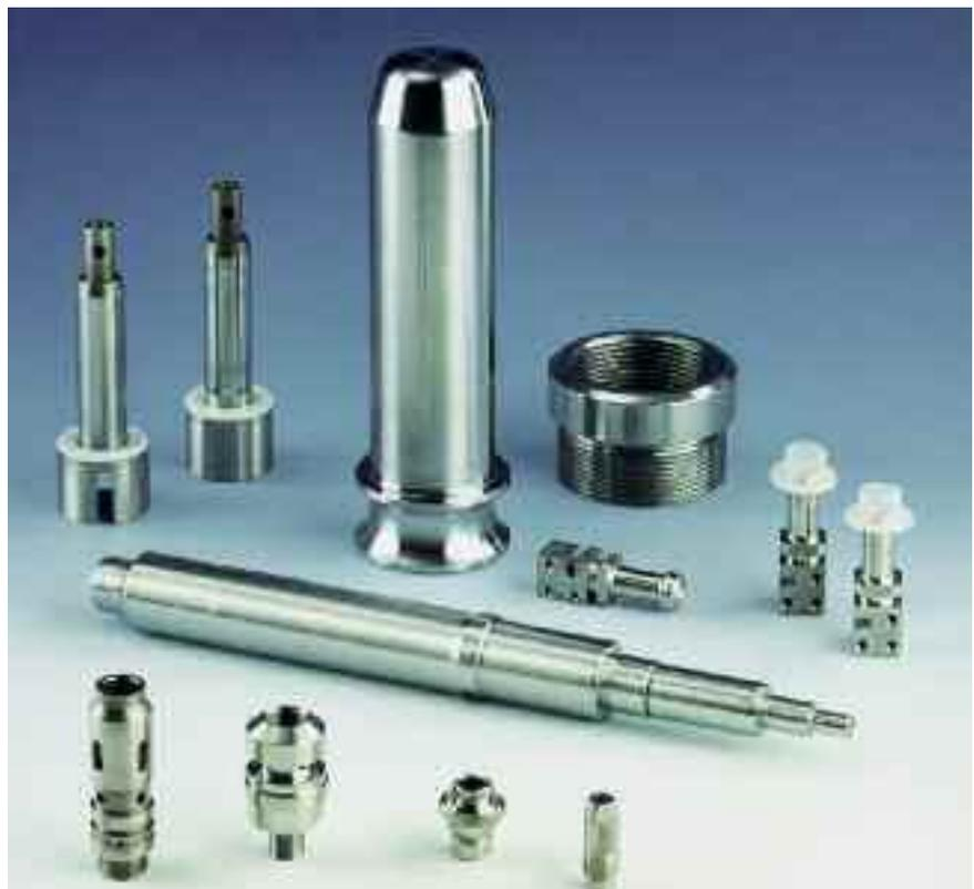
**Bild 8:** Drehteile aus Edelstahl Rostfrei
